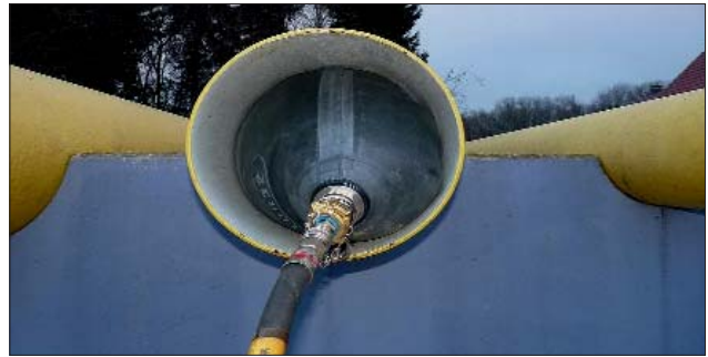
Достаточно иметь несколько пневмозаглушек LAMPE чтобы перекрыть любые нужные Вам диаметры труб
